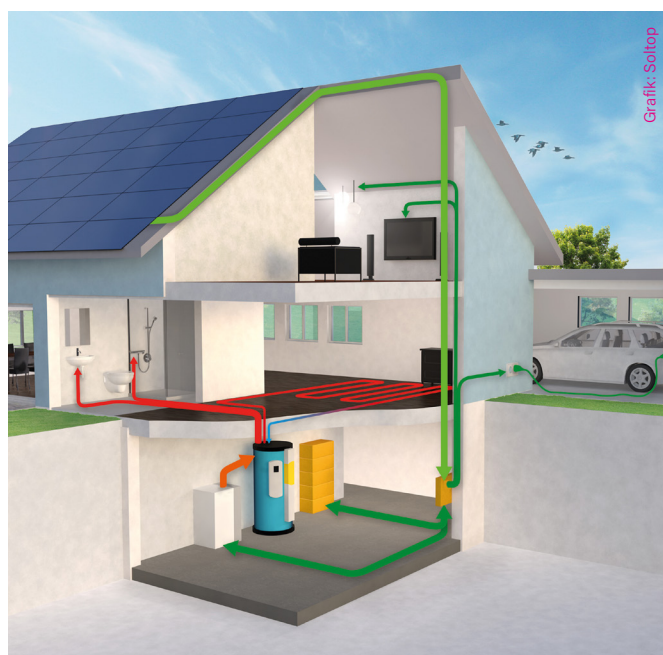
Figure 1) Le photovoltaïque, les pompes à chaleur et les systèmes de stockage de chaleur travaillent ensemble pour assurer un haut degré d'autosuffisance en eau chaude et pour le chauffage des locaux.
