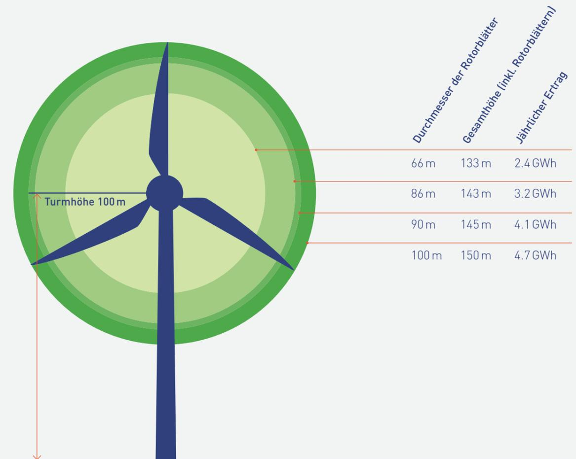
Nicht nur auf den Standort und die Turmhöhe der Windturbine kommt es an: Entscheidend für den Stromertrag ist der Rotordurchmesser.
